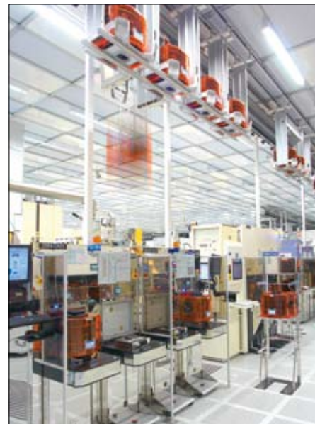
salle blanche Crolles 300mm et système de transport automatique
